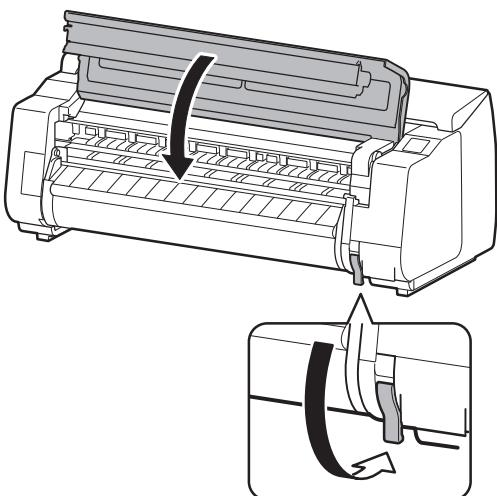
Abbassare la leva di rilascio e chiudere il coperchio superiore.
