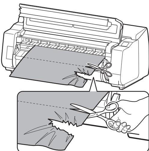
Tirate la porzione di carta inceppata in direzione della parte frontale. Utilizzate delle forbici o altro strumento di taglio per tagliare la porzione stampata o arricciata.
