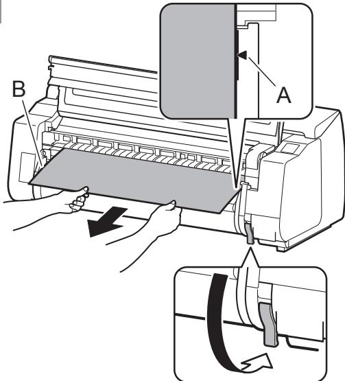
① Tirate fuori la carta in rotolo nella posizione della guida di uscita (B) in modo che il margine destro della carta in rotolo sia parallelo alla linea (A) e abbassare la leva di rilascio.
