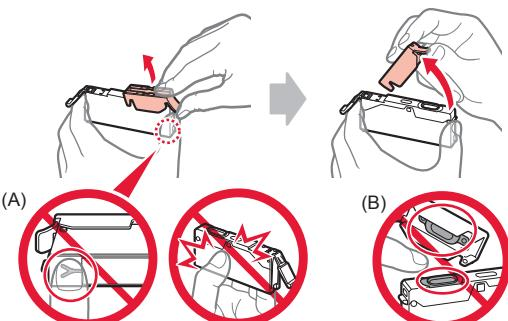
4 Vložte nádržku s inkoustem do držáku tiskové hlavy a pevně na ni zatlačte, dokud nezavakne na své místo.
