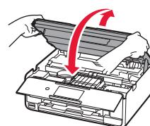
Jeśli pojawi się komunikat o błędzie, upewnij się, że zbiorniki z atramentem są zainstalowane prawidłowo.
