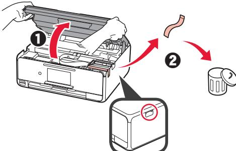
**3** PODIGNITE jedinicu za skeniranje / poklopac, a zatim ih zatvorite.
