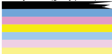
Rysunek 11-2 Kolorowe paski - nieregularne zabrudzenia lub zmniejszona intensywność (górnny pasek)
