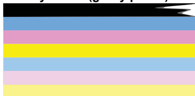
Rysunek 10-2 Kolorowe paski - nieregularne zabrudzenia lub zmniejszona intensywność (górnny pasek)
