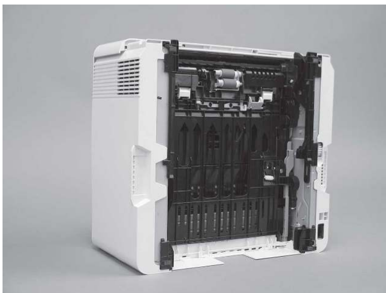
Rysunek 9-16 Umieść drukarkę spodem skierowanym do przodu
