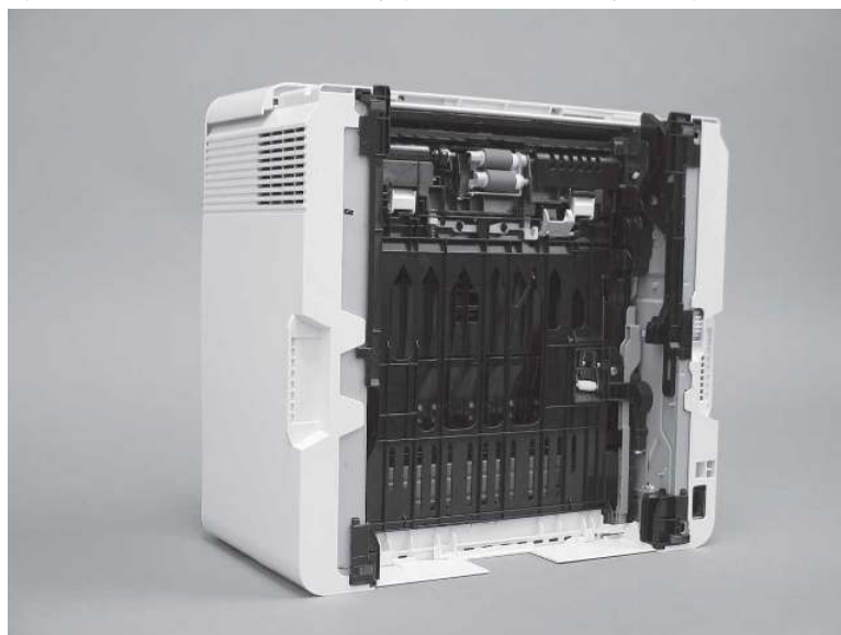
Rysunek 6-14 Umieść drukarkę spodem skierowanym do przodu
