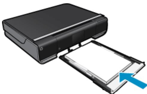
Insira a pilha de papel no centro da bandeja de papel com a borda curta para frente e o lado de impressão voltado para baixo. Empurre a pilha para frente para dentro da bandeja até ela parar. Deslize as guias de largura de papel para dentro até elas encostarem na borda do papel. Feche a bandeja principal.
