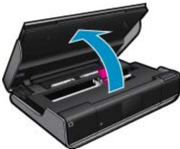
5. Remova qualquer papel ou objeto que possa estar limitando os movimentos do carro de impressão. Se a impressora for nova, remova qualquer material de embalagem.
