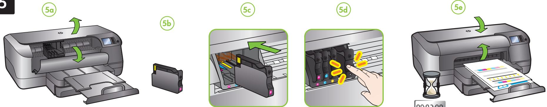
**DE** Setzen Sie die Tintenpatronen ein, und warten Sie, bis die Ausrichtungsseite gedruckt wird. Bei der Initialisierung des Druckers können Geräusche zu hören sein.
