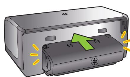
**PL** Zainstaluj moduł automatycznego druku dwustronnego HP (duplexer).
