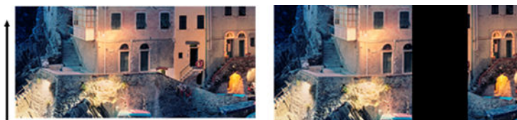
Original (Oryginalny) Skan z uszkodzonym modułem CIS
